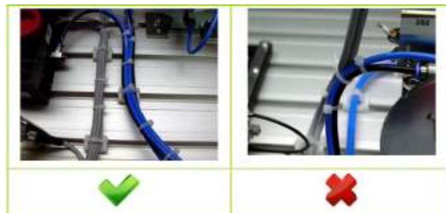
1.4) - Tubos pneumáticos paralelos no chicote (sem o "X" formado entre as tiras de plástico)
