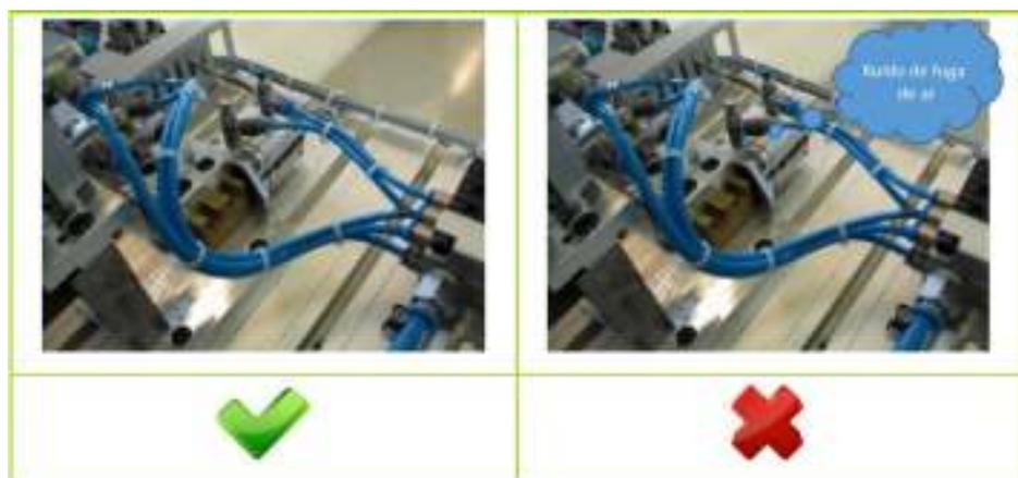
1.7) - Risco de colisão (durante os movimentos as peças do conjunto, não devem colidir com os fios elétricos e tubos pneumáticos)
