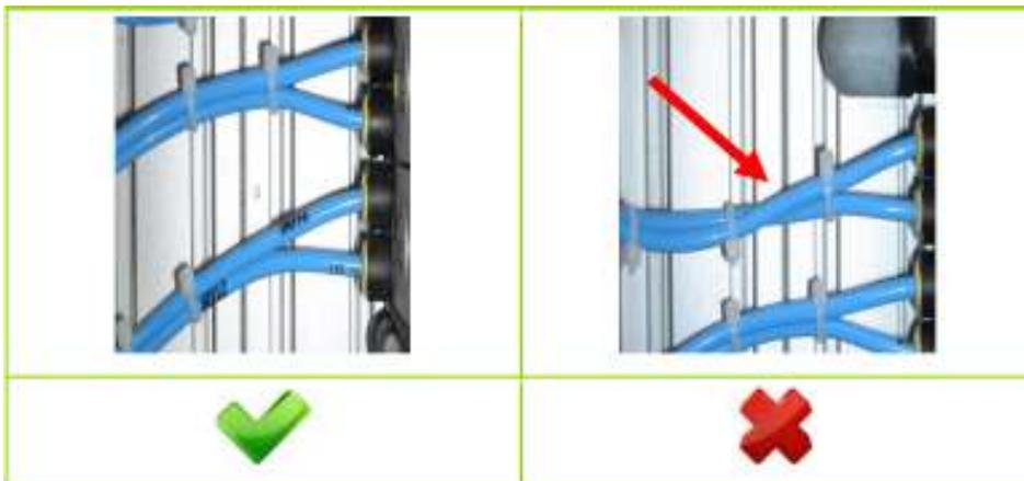
1.5) - Sem estrangulamentos na tubagem Pneumática
